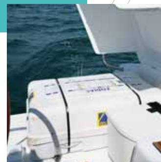
Coffre à BIB et à gaz avec ouverture assistée par vérin à gaz en inox • Liferaft and gas cylinder locker with stainless steel gas strut-assisted lid • Gavone zattera e per bombola gas con apertura assistita con attuatori in inox a gas • Cofre balsa salvavidas con abertura asistida por retenedor a gas inox • Backskiste für Rettungsinsel und Gasflasche mit Niro-Gaszylinder zum Öffnen
