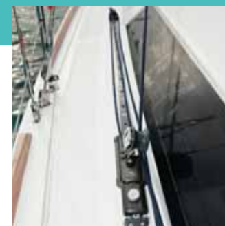
Pack easy sail: Réglage du chariot de génôis au cockpit • Easy sail pack: genoa traveller trimming from cockpit • Pack easy sail: Regolazione carrello genoa in pozzetto • Pack easy sail : Reglaje del carro escotero de genova en la bañera • Easy sail Pack: Genuaschlittenverstellung vom Cockpit aus
